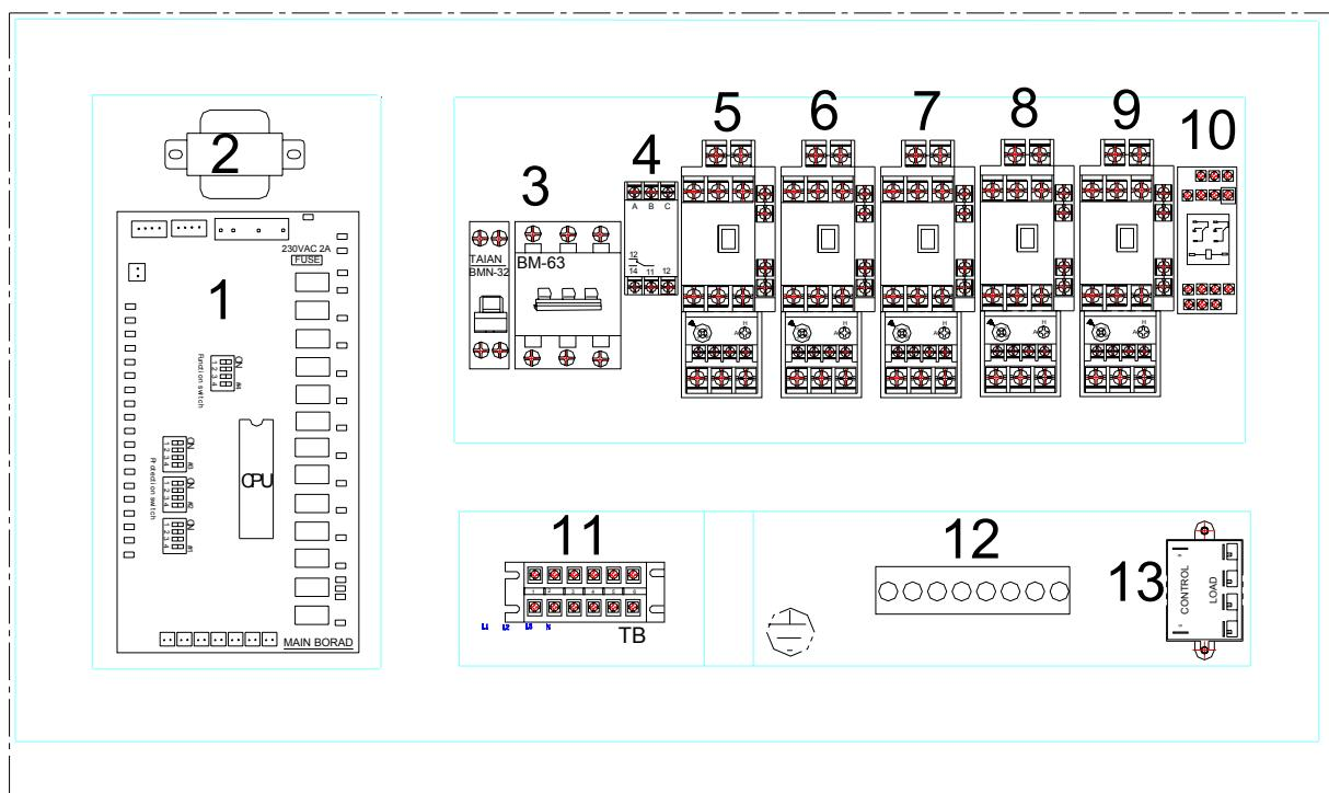
1.главная плата силового блока управления (PCB) 2.трансформатор 3.главный выключатель 4.защита
