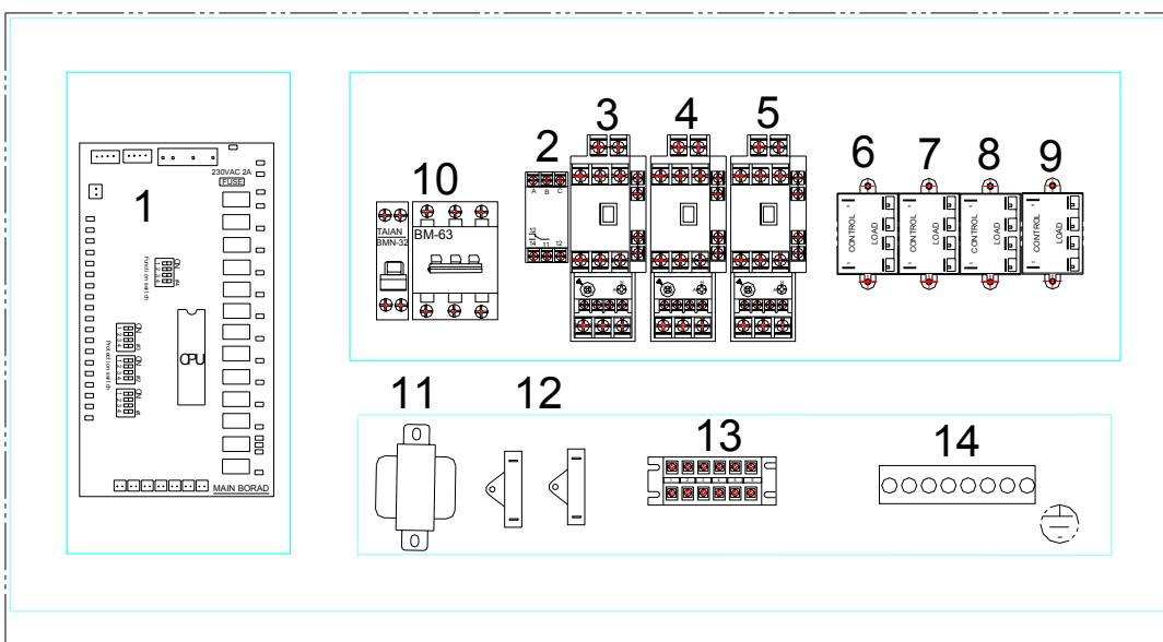
1.главная плата силового блока управления (PCB) 2.защита чередования фаз 3.4.термоконтакт компрессора
