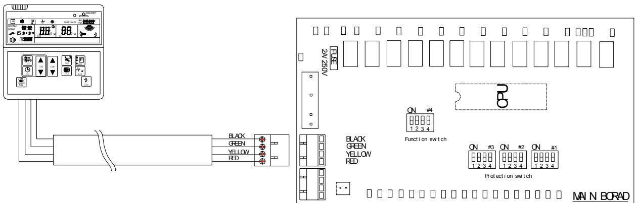
При независимом подключении электропитания 12VDC максимальная длина провода (соединения) может достигать 1200м. При зависимом подключении – 100м.
