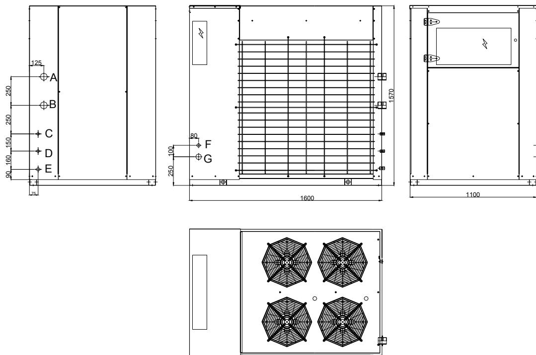
A: вход воды 1-1/4"(внутр. резьба) B: выход воды 1-1/4"(внутр. резьба)
