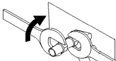
Патрубки теплообменника снажены клапанами для слива воды и спуска воздуха. При заполнении теплообменника тепло/холодоносителем необходимо стравить воздух, открыв клапан для спуска воздуха. Как только через этот клапан начнет выливаться тепло/холодоноситель, его необходимо плотно затянуть.
