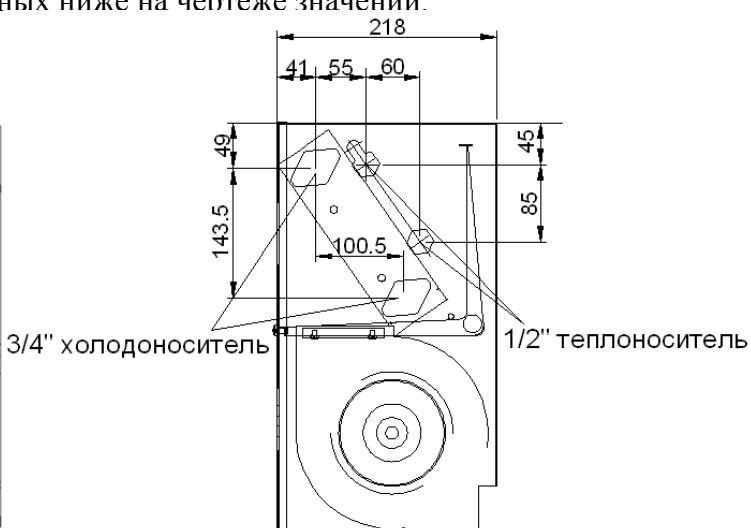
Подключение труб тепло/холодоносителя к фанкойлу должно быть произведено так, чтобы не вызвать чрезмерного механического напряжения на теплообменнике и патрубках.
