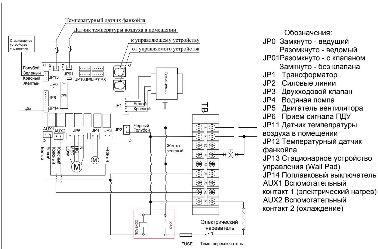
Принципиальная электрическая схема подключения фанкойла
