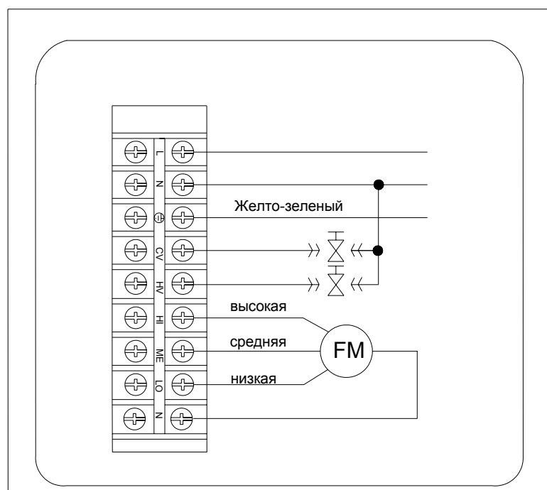
Принципиальная электрическая схема подключения фанкойла
