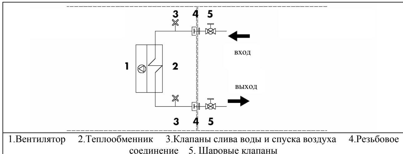
Поддержание заданной температуры воздуха в помещении осуществляется посредством количественного регулирования. Для этого магистрали тепло/холодоносителя должны быть оборудованы узлом регулирования, основным элементами которого является смесительный узел (поставляются в качестве аксессуаров (GVMC и GVCH)).
