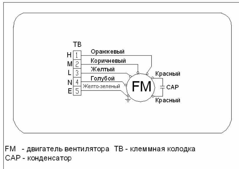
Принципиальная электрическая схема подключения фанкойла GCOX-P-...
