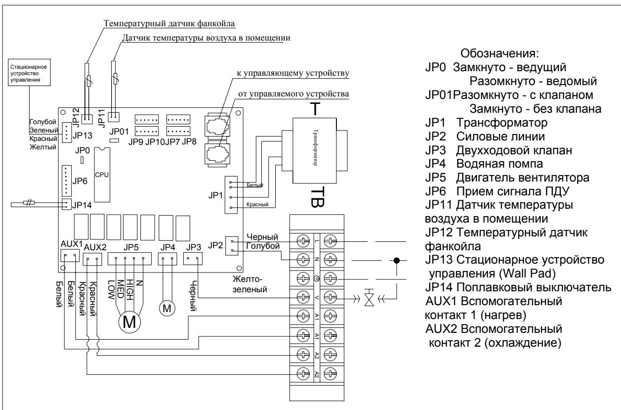
Принципиальная электрическая схема подключения фанкойла GCOX -V с встроенным комплектом электронного оборудования (KIT Wall Pad) и электрическим нагревателем
