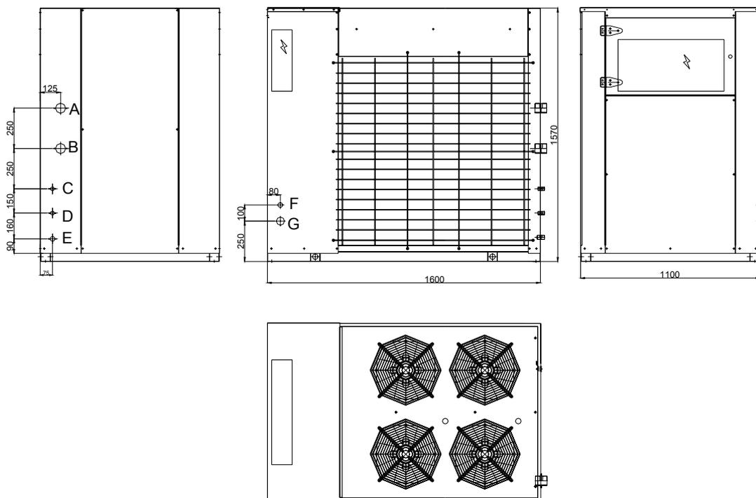
A: вход воды 1-1/4"(внутр. резьба) B: выход воды 1-1/4"(внутр. резьба) C: клапан заполнения гидравлического контура 1/2"(внутр. резьба) D: выход предохранительного клапана 1/2"(внутр. резьба) E: дренажный патрубок 3/4" F: электроподключение G: электроподключение
