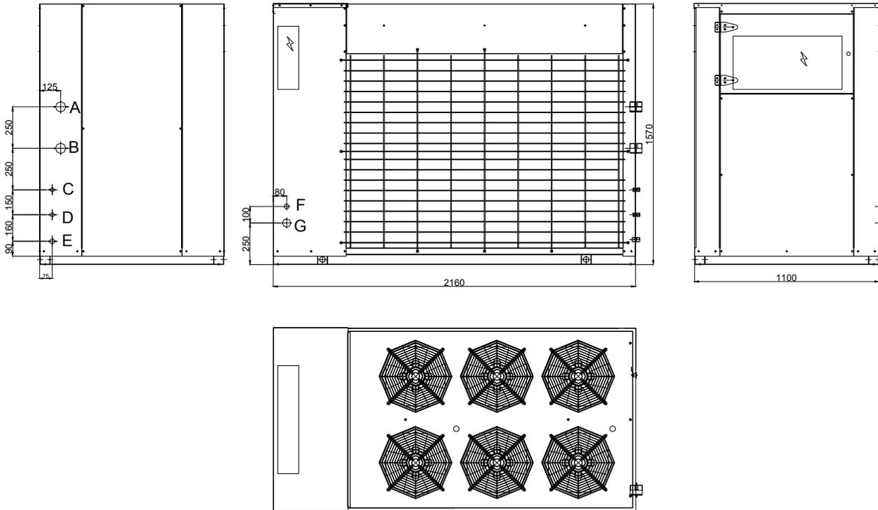
A: вход воды 1-1/4" (внутр. резьба) B: выход воды 1-1/4" (внутр. резьба) C: клапан заполнения гидравлического контура 1/2" (внутр. резьба) D: выход предохранительного клапана 1/2" (внутр. резьба)
