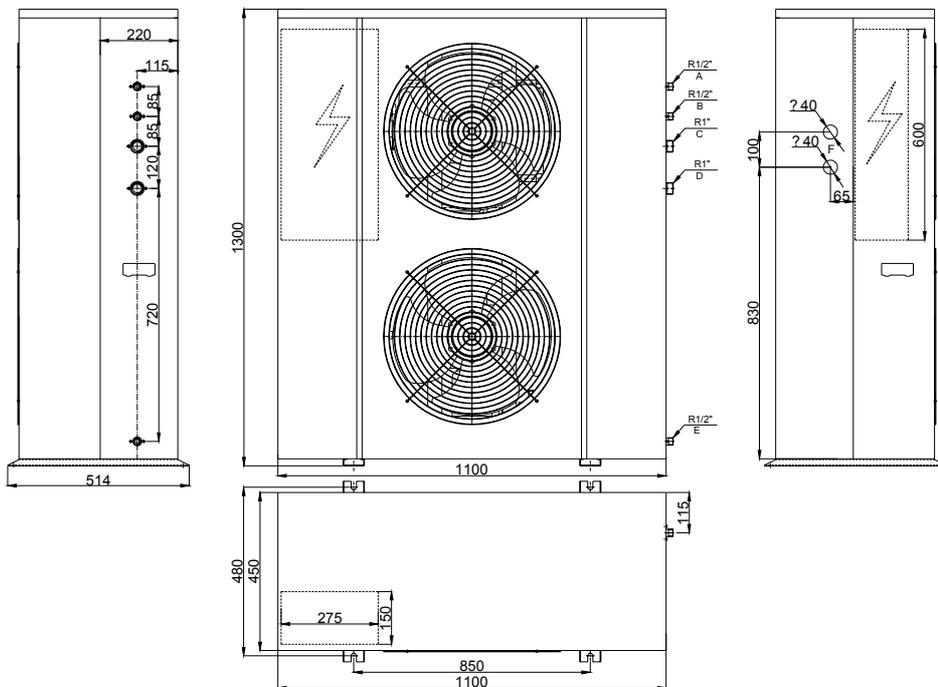
A: выход предохранительного клапан 1/2"(внутр. резьба)
