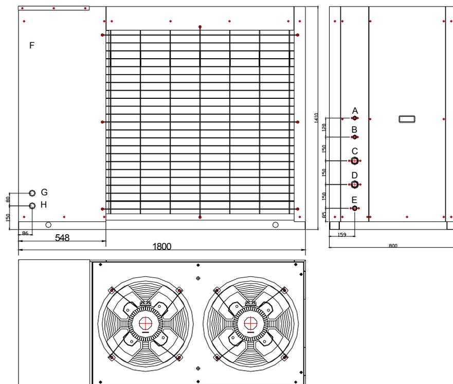
A: клапан заполнения гидравлического контура 1/2"(внутр. резьба) B: выход предохранительного клапана C: вход воды 1-1/4"(внутр. резьба) D: выход воды 1-1/4"(внутр. резьба) E: дренажный патрубок 3/4" F: щит управления G: электроподключение H: электроподключение
