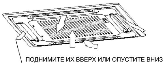
Когда включена эта функция, работает отклоняющий вентилятор внутреннего блока; в противном случае отклоняющий вентилятор не работает. Регулировка отклонения потока воздуха в обе стороны от 0 – 30°. Когда воздушный кондиционер не работает (включая режим "TIMER ON" (ВКЛЮЧЕНИЕ ПО ТАЙМЕРУ)), кнопка **SWING** не работает.
